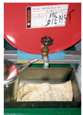
Oil Plus-doeken onder lekkende oliekannen en vaten.
