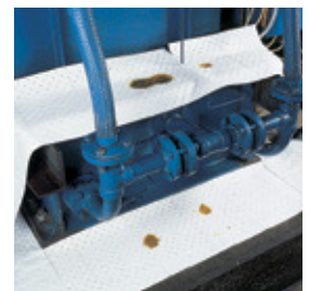
...of rond en onder machines om lekken en spatten op te vangen.
